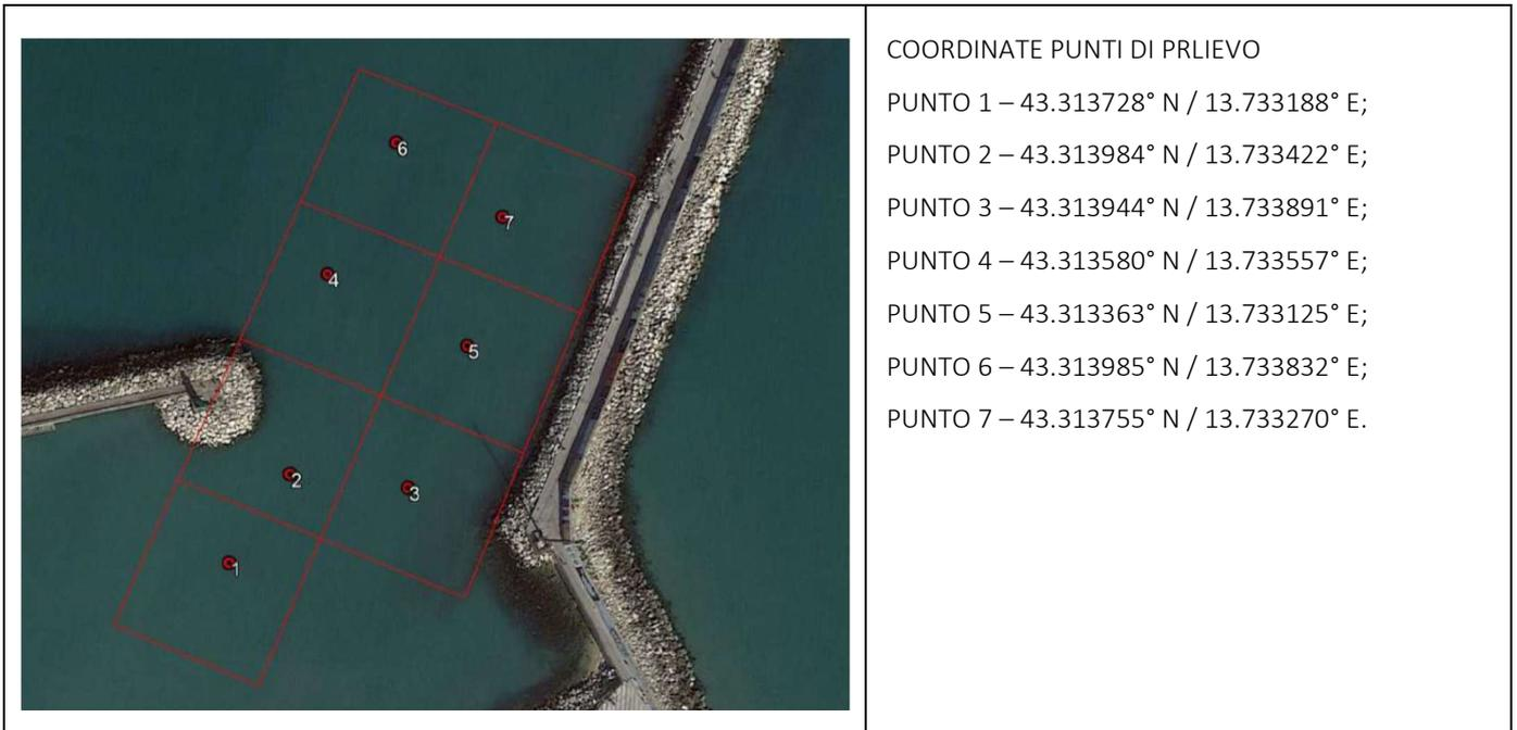
Figura 4. Maglia di campionamento e coordinate di punti di prelievo.
